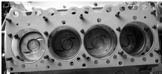
Een nieuwe koppakking wordt geplaatst.
